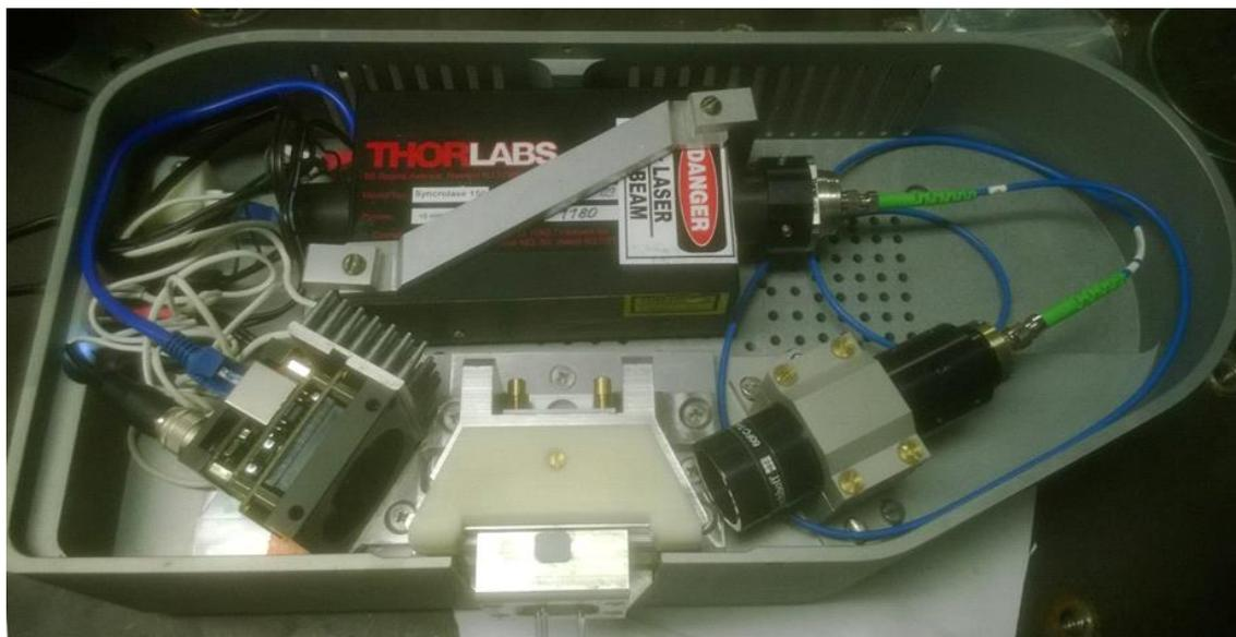
Рисунок 2 - Внутреннее устройство прибора Плазмон-БИО
