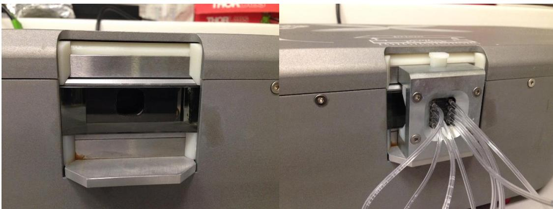
Рисунок ПЗ - Призма прибора без подсоединенной ячейки с сенсором и в сборе.
